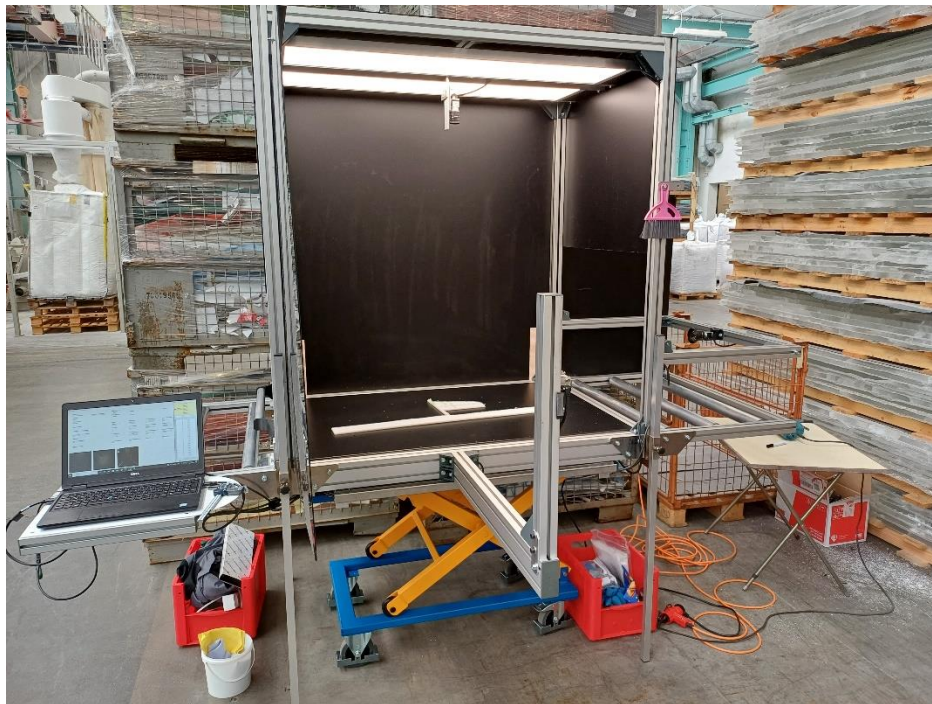
Abb. 7: Sortierprüfstand für PMMA-Plattenware für den Feldversuch
