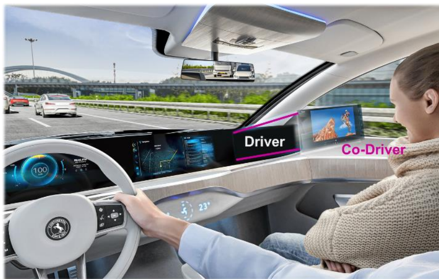
Abb. 7: Switchable Privacy Display: der Fahrer erkennt den Display-Inhalt nicht, während der Beifahrer den Film auf dem Display ungehindert sehen kann. Quelle: Continental – angepasst
