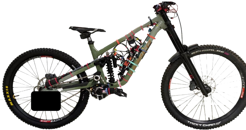
Abb. 10: Norco Shore Messrad (Größe L aus 2022) mit Sensorik für die Ermittlung von störenden Kräften in die Füße des Fahrers
