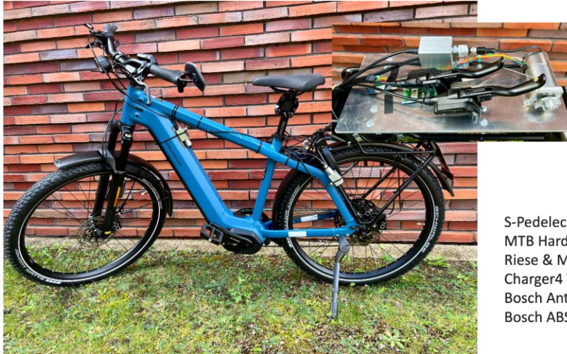
Abb. 9: S-Pedelec-Versuchsträger mit Hardware für elektronischen, softwarebasierten Bremskraftverteiler
