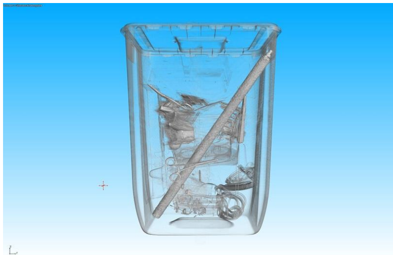
Abb. 13: CT-Scan eines Modellbehälters zur Charakterisierung infektiöser Abfälle aus dem Gesundheitswesen. Quelle: Zeiss
