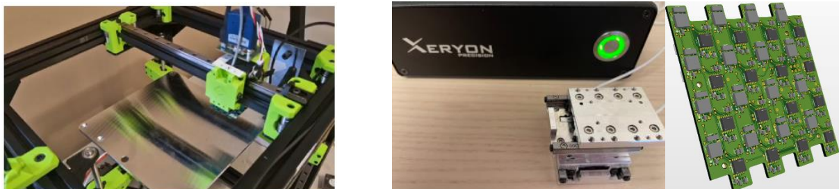
Abb. 15: 3D-Magnetscanner (links) und 2D-Magnetometer auf XY-Tisch (rechts)
