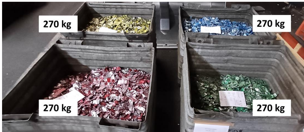
Abb. 8: Zerkleinerte und lackierte Aluminium-Stanzschrotte für Einfahrversuche
